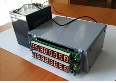
Şəkil 4.9. Avtogeneratorlar metal gövdədə və hermetik qabda
