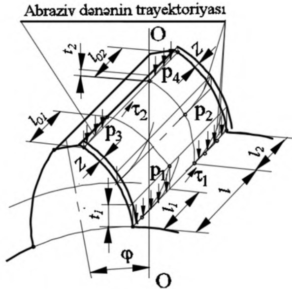
Şəkil 1. Dişlərin sürətköçürmə ilə pardaqlanmasında səthə təsir edən dəyişən amillər
