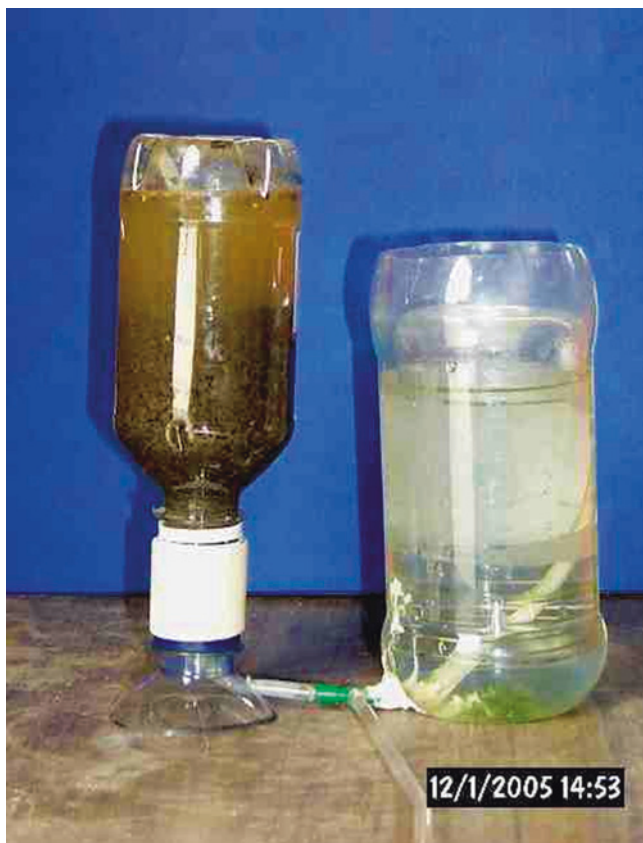
Fig. 7 Mini digester (Indian type batch unit)
